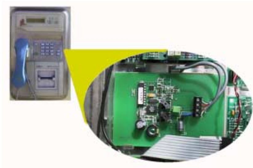
Nyilvános készüléknék alkalmazott egység képe (Monetel)
