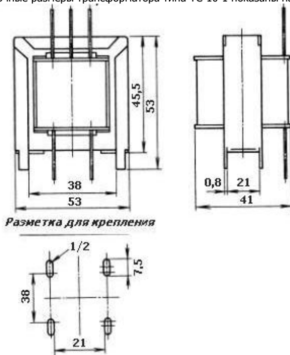
Рис.1. Размеры трансформатора типа ТС-10.
