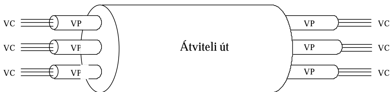
13. ábra. A virtuális csatornák a virtuális utakon belül találhatóak
